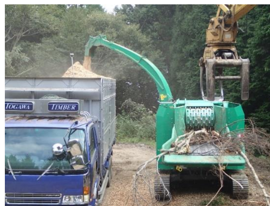
移動式チップパーによる破碎作業
