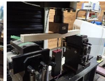
製材後の強度試験
