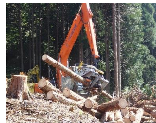
高性能林業機械による造材作業
