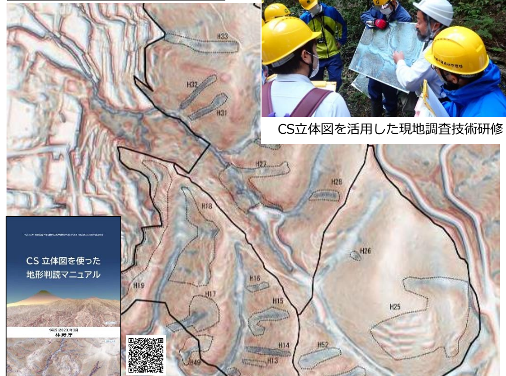
CS立体図を活用した森林の微地形（主な変状地形）の抽出事例（災害リスクの検討）
