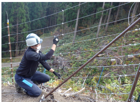
積雪地域における防護柵の 耐久性検証試験 (鳥取県倉吉市 西鴨国有林)
