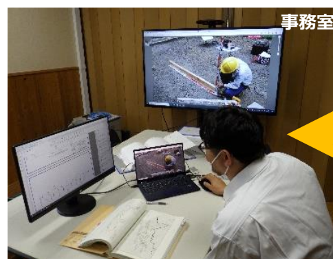
ウェアラブルカメラを利用した遠隔臨場の実施事例
