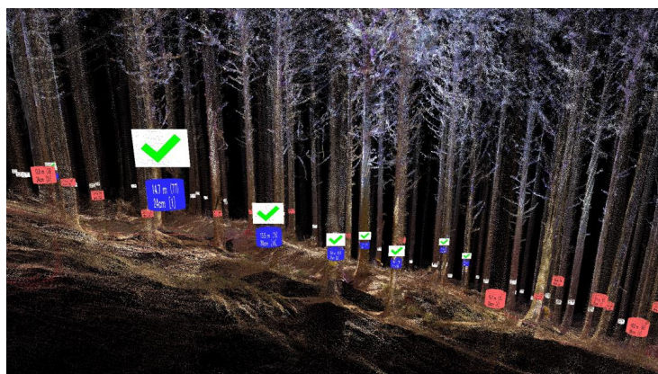
3次元地上レーザスキャナによる林分解析画像
