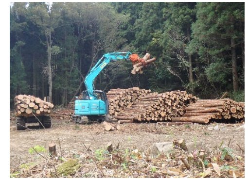
【中間土場での積卸・仕分作業】
