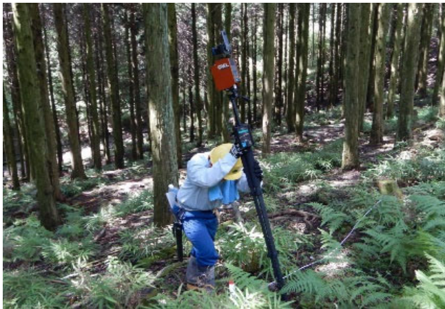
【3次元地上レーザースキャナの使用状況】
