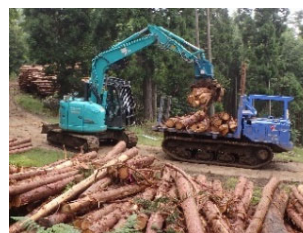
【中間土場での積卸作業】
