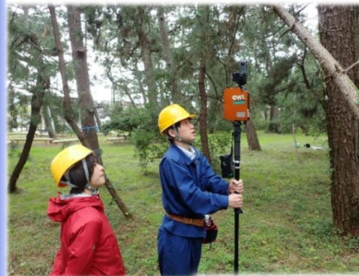
地上レーザスキャナによる収穫調査
