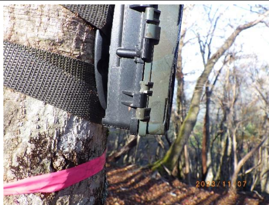
S25 : 破損状況 蝶番が破損
