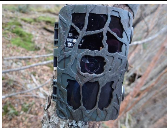
R2-9 : 破損状況 上部の赤外線 LED が破損
