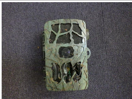
S20 : 破損状況 下部のセンサーが破損
