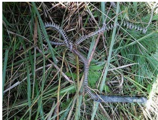
写真Ⅲ2-25 足くくりわなでの捕獲に成功したが、わなを破壊して脱走。拘束部のワイヤーがちぎれていた。この捕獲の後、地点 NT-03 にシカは1頭も現れなかった。 (LT-12: 平成29年10月26日)
