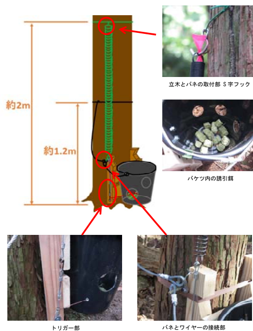
図Ⅲ2-1 首用くくりわなの構造
