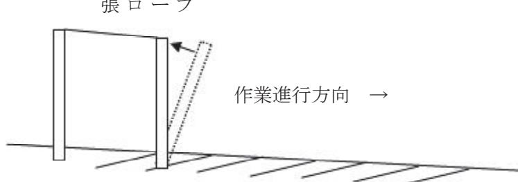
ロープの張力により支柱を引き起こし垂直(最もネットが高く)に仕上げる。
