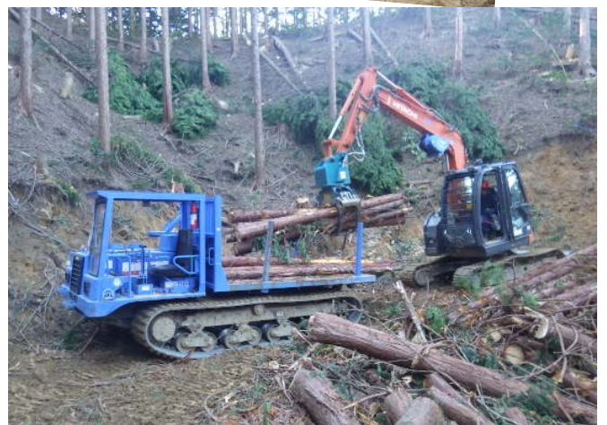
グラップルによる集材積み込み作業
