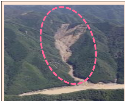
野尻工区 (被災直後) ・崩壊規模 20.44ha ・対策：谷止工、山腹工
