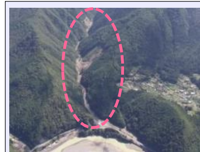
高津工区 (被災直後) ・崩壊規模 2.67ha ・対策：谷止工、山腹工 (平成30年度工事完了・移管済)
