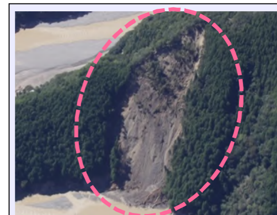
折立工区 (被災直後) ・崩壊規模 2.36ha ・対策：山腹工 (平成27年度工事完了・移管済)
