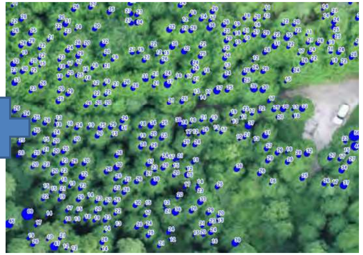
地上レーザによる胸高直径計測
