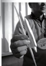
丸太の表面に人工的に凹凸の紋をつけるためのあて木。(昔は板や竹、ツツジ等が使われていたが、現在では腐りにくいプラスチックで流し模様をつくり木に巻きつけている。)
