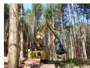
高性能林業機械 (ハーベスタ) による玉切り作業
