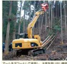
アームをタワーとして使用し、主索を用いない簡易な架線による集材機
