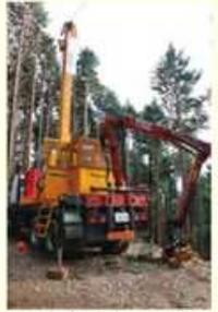
簡単に架線集材材できる支柱を装備した集材機
