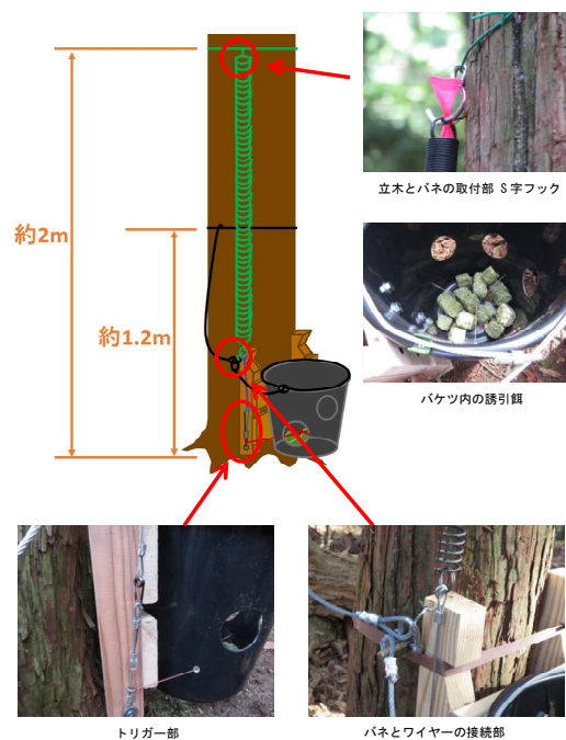
図Ⅲ2-1 首用くくりわなの構造
