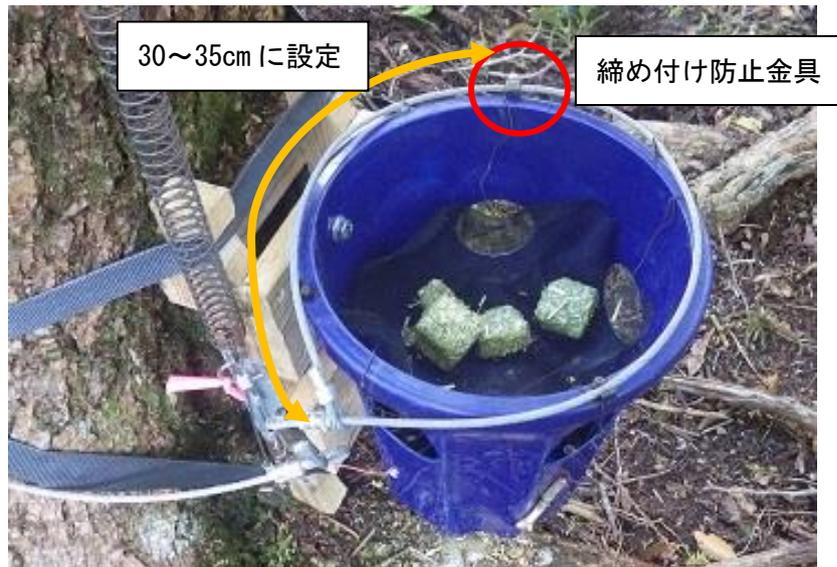
写真 2-3 締め付け防止金具
