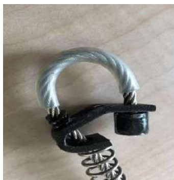
写真3 シリコンチューブで保護したくくりわな
