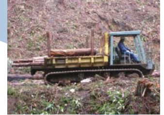
林内作業車により集材(土場へ)
