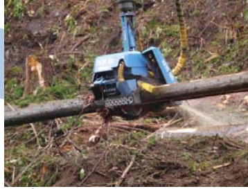
プロセッサにより枝払い・造材
