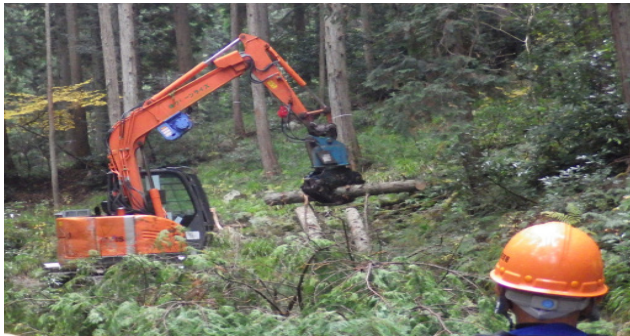
グラップルによる作業の様子（八ツ尾山国有林）
