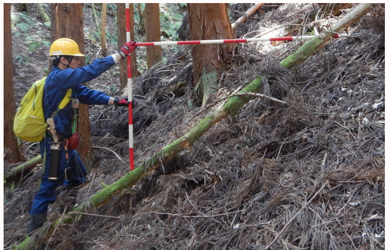
林内でポールを使って勾配を測定しています。
