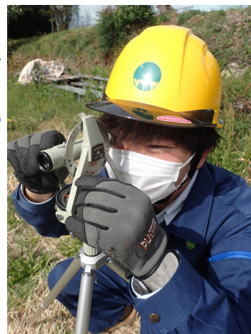
コンパス測量の様子
