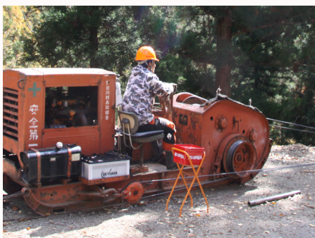
【集材機（ヤード）】
