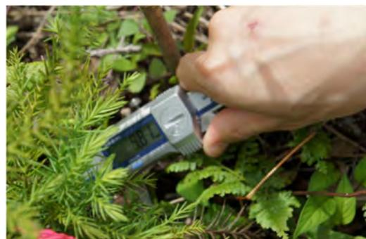
写真-2 根本径測定
