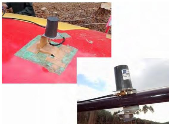
図－9 機体の動きを計測
