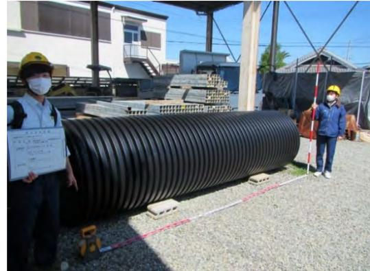
図-1 TAC パイプ (大型排水管)
