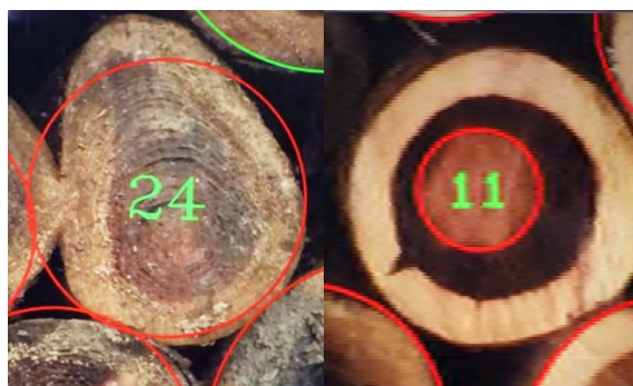
写真－4 計測場所を誤認識した楕円形の丸太と、変色した丸太
