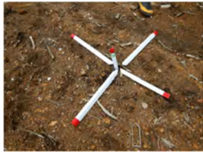
写真-4 対空標識
