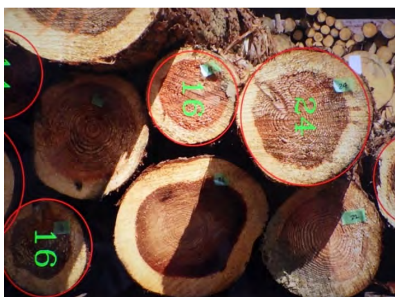
写真－3 上段の丸太の影によって認識されない下段の丸太
