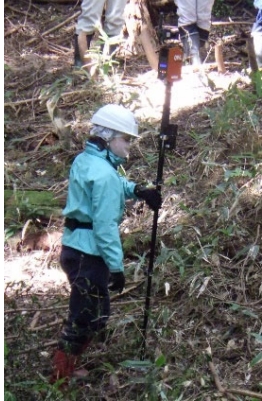
現地計測 地上型3Dレーザスキャナ (OWL)
