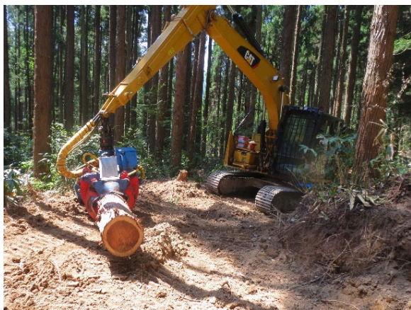
高性能林業機械(プロセッサ)による造材(十方山国有林:廿日市市)
