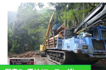
写真5 運材(フォワーダ) 一般材と低質材の積み合わせ
