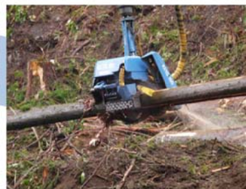
プロセッサにより枝払い・造材
