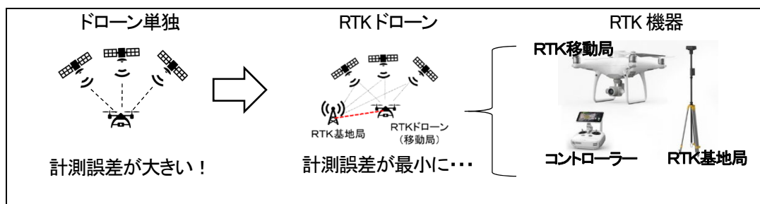
図-1 RTKの仕組み
