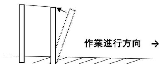
ロープの張力により支柱を引き起こし垂直（最もネットが高く）に仕上げる。
