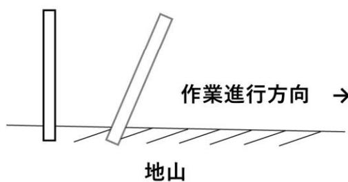
支柱は作業進行（斜面下方）方向へ傾けて打ち込む。
