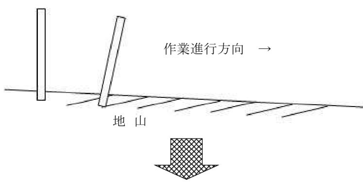
支柱は作業進行(斜面下方)方向へ傾けて打ち込む。
