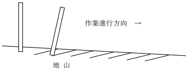
支柱は作業進行(斜面下方)方向へ傾けて打ち込む。
