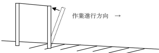
ロープの張力により支柱を引き起こし垂直(最もネットが高く)に仕上げる。
