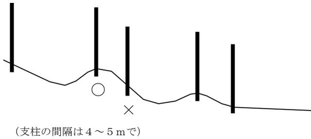
支柱の打込箇所は地山の凹凸がある場合、ネットの高さを確保するため、できる限り凸部分に打ち込む方が良い。
