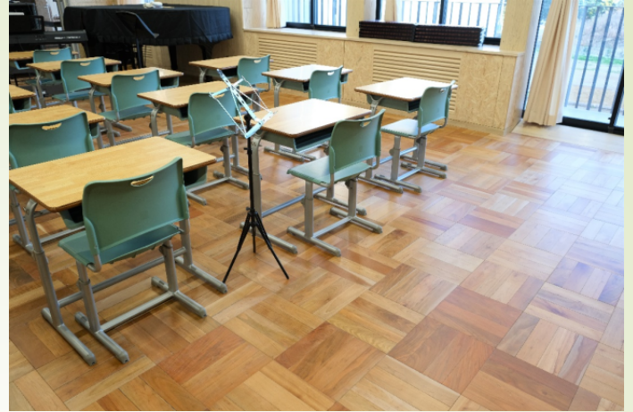
特別教室の図工室（左上）と音楽室（右上）。図工室の床板はクリ材、音楽室の床板にはサクラ材が使用されていて、教室全体の印象が変わります。授業時の心理的効果も感じ取ることができます。
