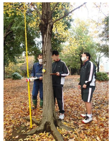
輪尺を使って直径を計測
