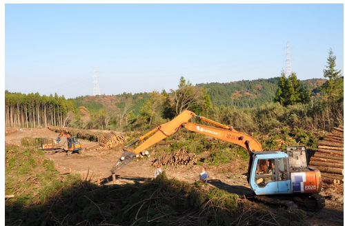
アイアンフォークバケットを使用した地拵え作業の実演
