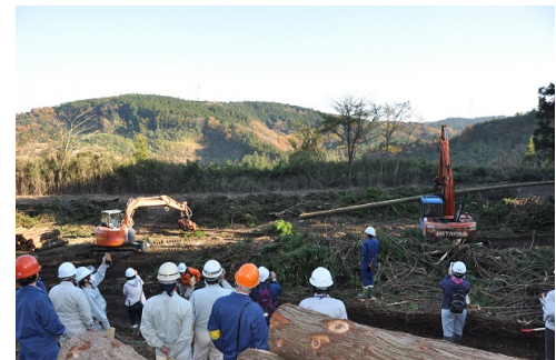
アイアンフォークバケットとプロセッサを使用した集材・玉切り作業の実演
