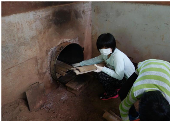
ドラム缶釜に炭材の竹を詰める
