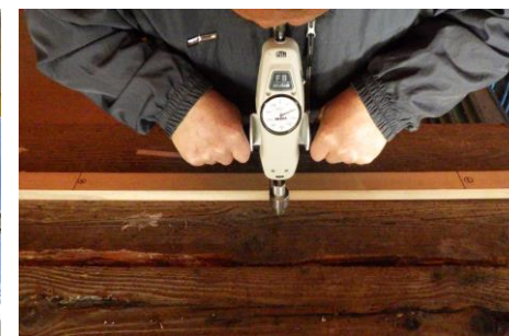
写真2 フォースゲージ貫入試験の様子
