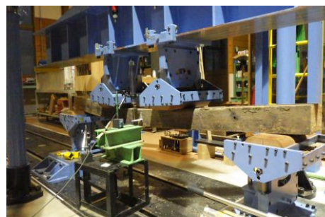
写真1 曲げ試験の様子
