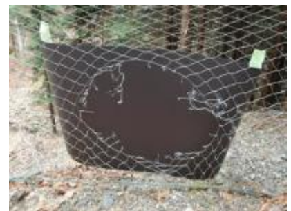
図－2 軟質ステンレス鋼線入り ネットの動物による切断
