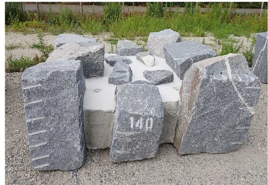
（写真-5）自然石被覆ブロック
