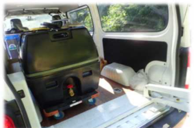
高圧洗浄機と水タンクを軽トラック等に積載したまま林道等の除草が可能
