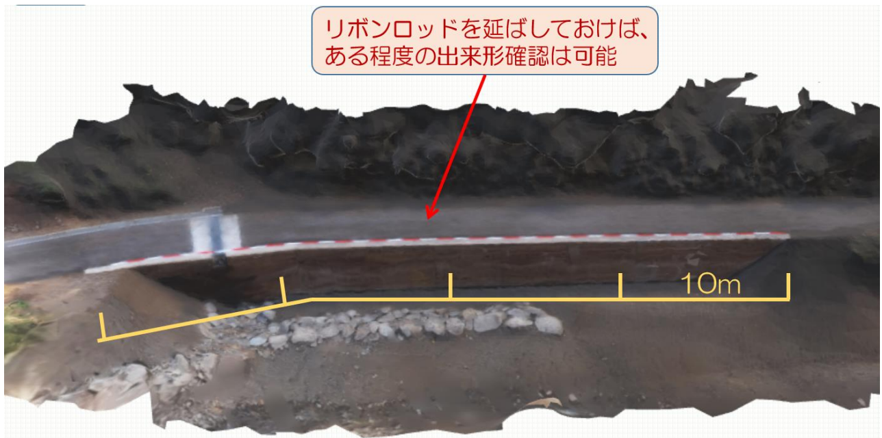
図一八 完成時の 3D モデル
