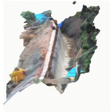
図一七 型枠完了時の 3D モデル
