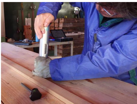
図3 打込み、貫入試験の様子(ピロディン打込み)
