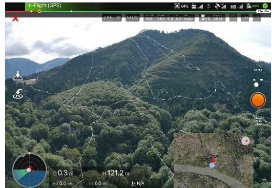
図 4. 境界線データと境界点データを表示 (UAV で撮影)
