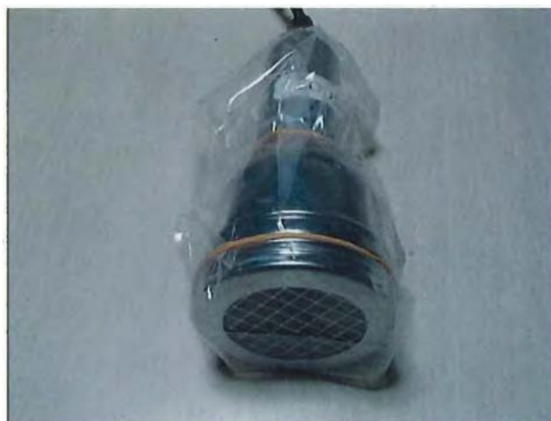
写真7 サーベイメータのビニール養生例
