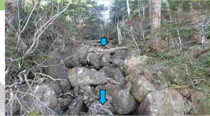
田代山湿原から滑落崖に続く水みちの状況 (巨礫が露出し豪雨時の表流水発生が推察)
