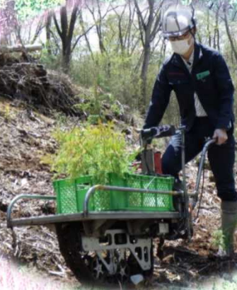
電動苗木運搬車実証試験
