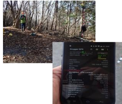
GNSSによる周囲測量の様子と現地データ
