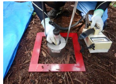
土壌の表面線量率測定状況 (福島県川俣町)
