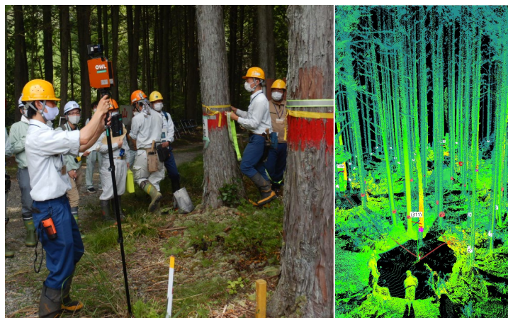
3次元レーザースキャナシステムによる森林資源量調査 (近畿中国森林管理局) 調査の様子(左)と得られた3次元地図(右)
