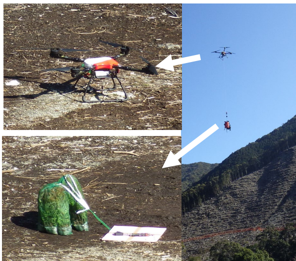
無人航空機による造林資材(苗木)の運搬(右) (四国森林管理局) 無人航空機(左上)と運搬している苗木(左下)
