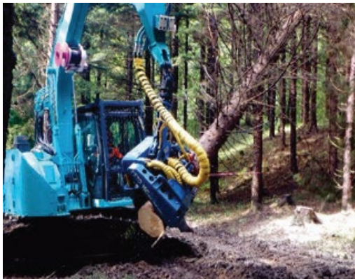
高性能林業機械による伐倒
