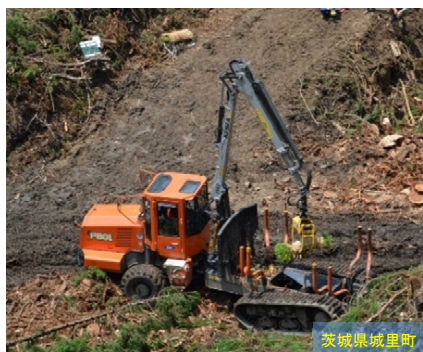
集材に使用したフォワーダによる苗木の搬送
