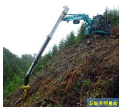
集材時に使用したグラップルによる地拵作業
