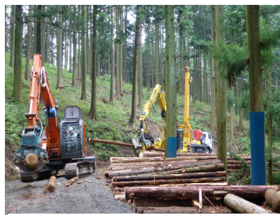
高性能林業機械による集材・造材作業 （掛川市黒俣地域民有林）
